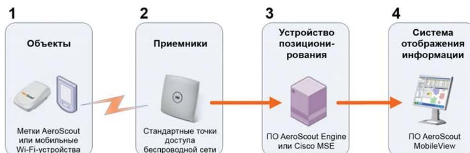
1. Активная RFID-метка и/или обычное беспроводное устройство посылает беспроводной сигнал.
