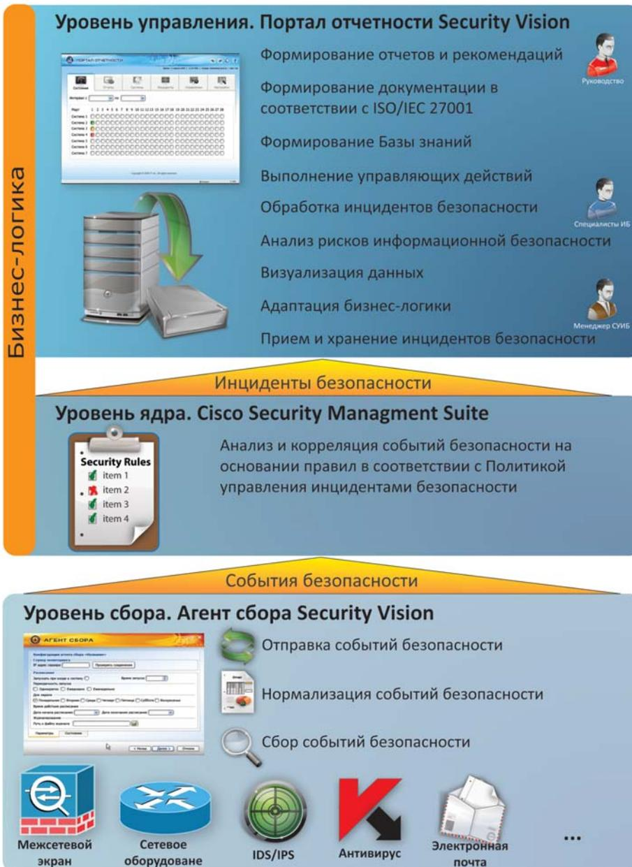
Список подключаемых систем может расширяться в зависимости от потребностей предприятия. Уровень сбора построен на базе ПО Агент сбора Security Vision. Преимуществом Агента сбора является работа с любыми IP-ориентированными приложениями и системами безопасности. Модули Агента сбора позволяют подключать информационные системы предприятия к Центру управления безопасностью Security Vision. Данные разработки проводятся совместно с экспертами компании Cisco Systems.
